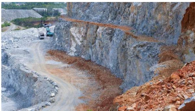
รูปที่ 7: การลงดินเตรียมปลูกต้นไม้ฟื้นฟูบนชั้นบันไดที่สิ้นสุดการทำเหมืองแล้ว
